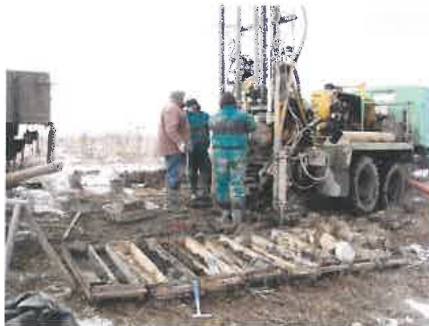
Obrázek 2: Vrtání, jádro uložené ve vzorkovnicích
